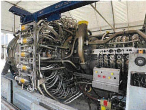
ภาพที่ 2.2-1 ระบบหัวฉีดเผาไหม้แบบ Dry Low No x Burner
